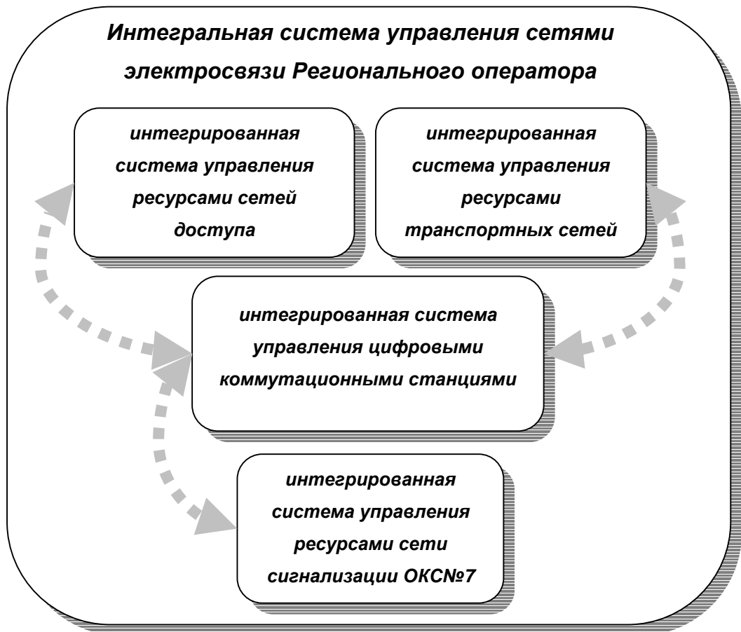
Рис. 1.0. Организация взаимодействия интегрированных систем управления в рамках интегральной системы управления.
