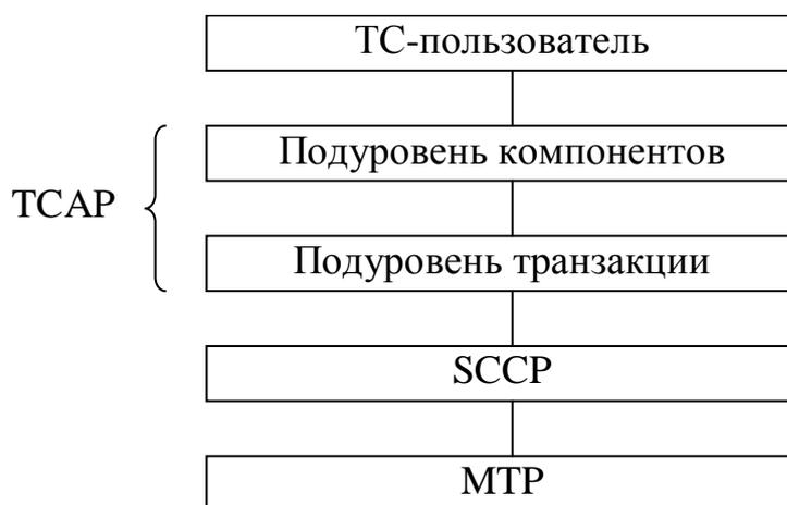
Рис. 2.1. Архитектура подсистемы TCAP и ее положение в ОКС №7.
